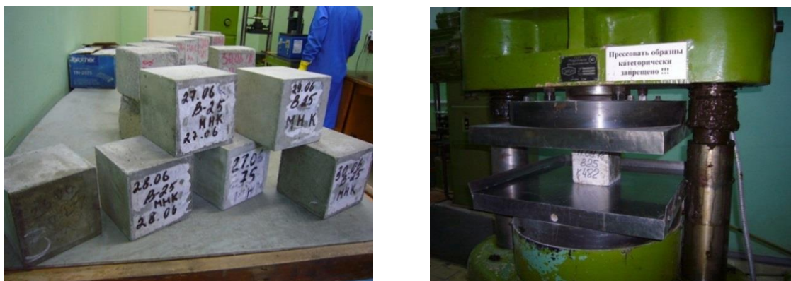
Рис. 1. Испытание кубов бетона в лабораторных условиях
