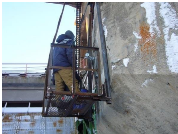
Рис. 3. Испытания прочностных свойств бетона на водосбросе Нижне-Тулумской ГЭС
