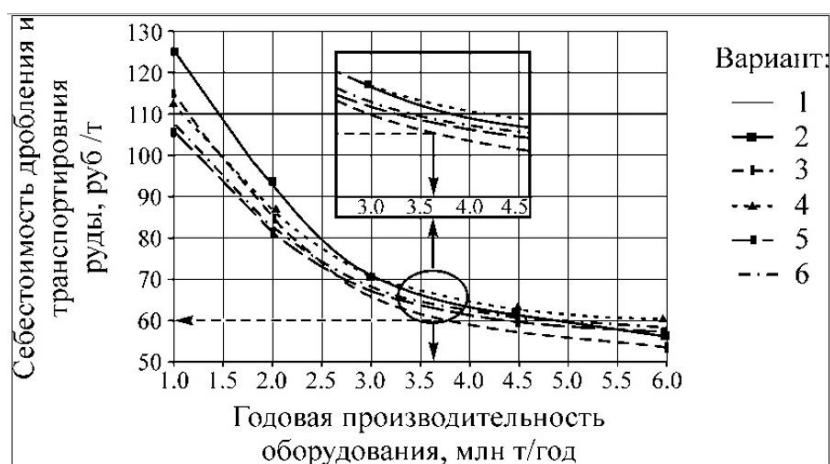
Рис. 4. Зависимость себестоимости дробления и транспортирования руды при наращивании производственной мощности
