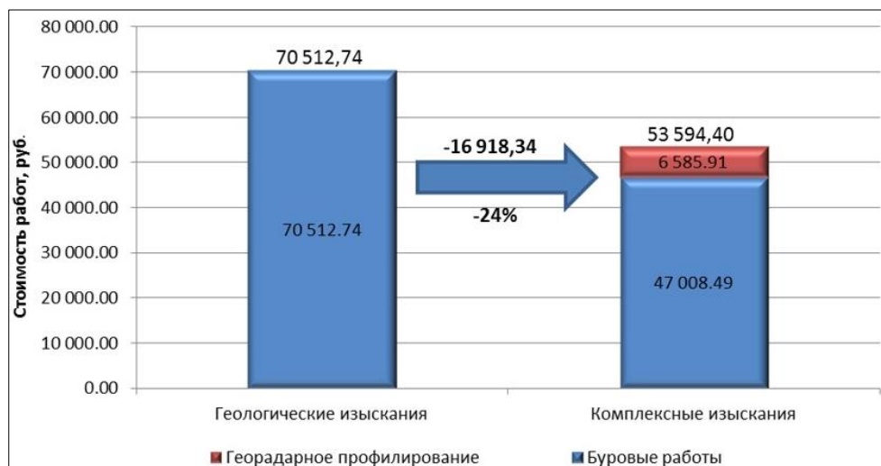
Рис. 3. Снижение стоимости инженерных изысканий при комплексировании буровых работ и георадарного профилирования
