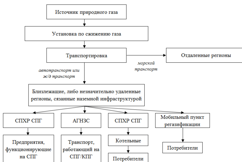
Рис. 1. Альтернативные варианты реализации СПГ: СПХР СПГ — система по приему, хранению, выдаче и регазификации СПГ; АГНЗС — автомобильная газонаполнительная компрессорная заправочная станция
