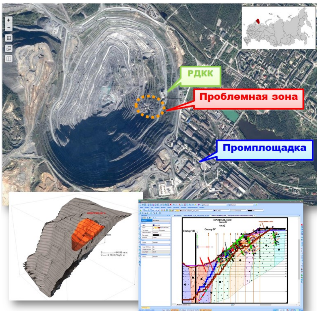
Рис. 5. Спутниковый снимок карьера «Железный» АО «Ковдорский ГОК» с изображением 3D-модели неустойчивой зоны на восточном борте (Д. В. Жиров, 2014) и его геологического разреза (АО «МГРЭ», 2017)
