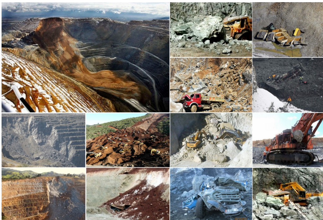
Рис. 1. Аварии на различных карьерах в результате развития опасных геологических процессов (оползней, камнепадов, обрушений и т. д.)
