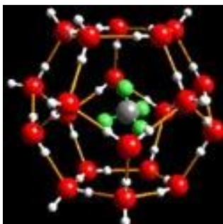
Рис. 2. Структура газового гидрата
