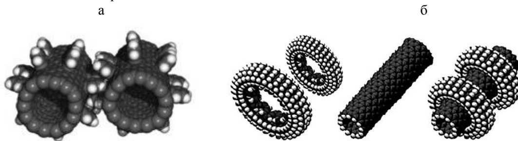
Рис.16. Молекулярные шестерни (а) и ось наноколес (б)
