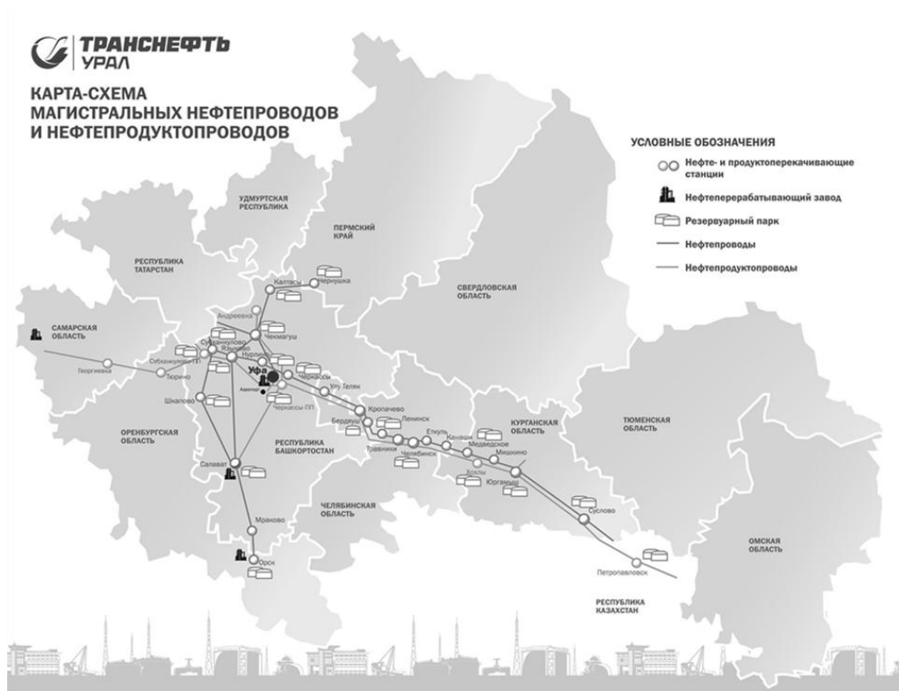
Рис. 54 Карта-схема магистральных нефте- и нефтепродуктопроводов ПАО АНК «Транснефть» дочернего предприятия ООО «Траснефть-Урал»
